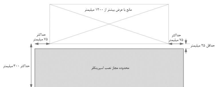
شکل ۴-۶-۲۰- محل نصب اسپرینکلر در زیر موانع عریض
