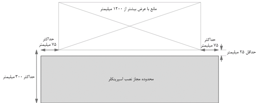
شکل ۲۶-۷-۴- محل نصب اسپرینکلر در زیر موانع عریض
