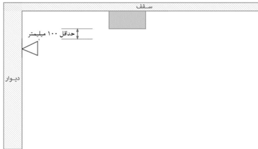
شکل ۴-۶-۲۲-ج- صرف نظر کردن از موانع روبه روی اسپرینکلر دیواری مسکونی
